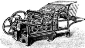
**Einfache Buchdruckschnellpresse** mit 2 u. mit 4 Auftragwalzen.
